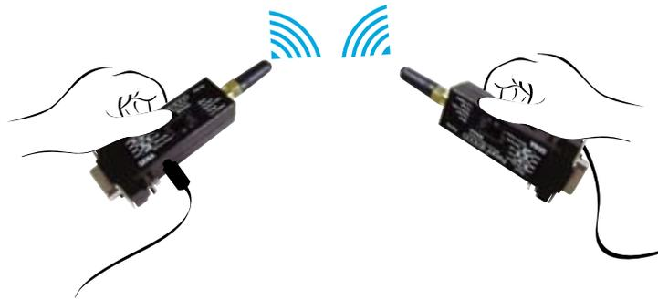
Die Parani Adapter haben einen Taster (Pairing) für die schnelle Verbindung zwischen zwei Adaptern auch ohne dafür einen PC bzw. Software zu benötigen. (Nebenstehend bezeichnen wir die zwei Bluetoothadapter als SD1 und SD2)
